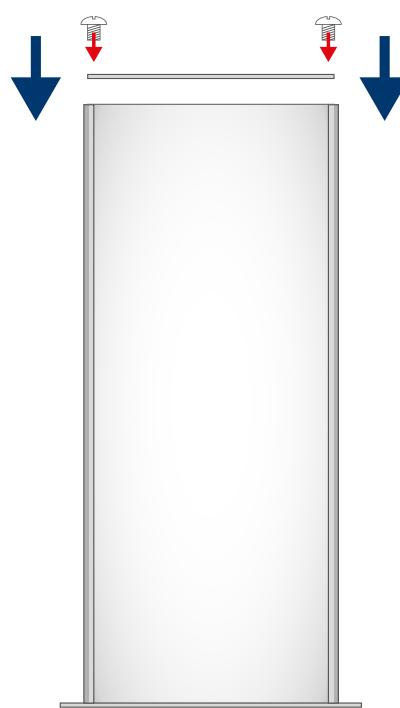
4. Applicare il coperchio superiore e fissare con le viti in dotazione.
