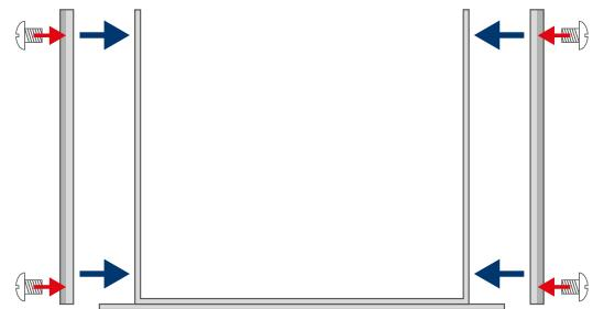
2. Applicare le spalle al telaio e fissare con le viti in dotazione.
