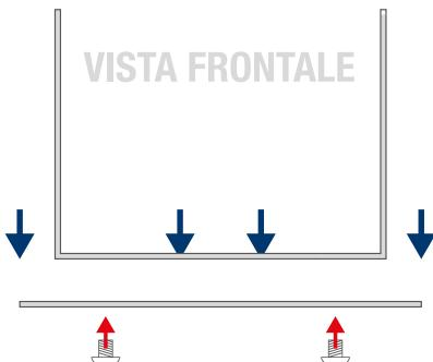
1. Fissare il telaio alla piastra rettangolare con le viti in dotazione.
